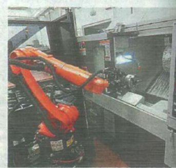
Hi-tech Il sofisticato tornio è dotato di un braccio robotico a
